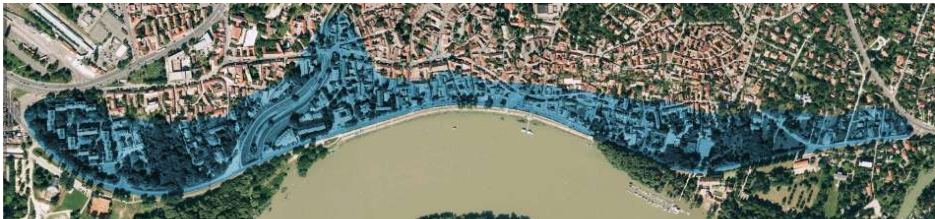
3./3. ábra - Gátszakadás esetén elárasztással veszélyeztetett terület
